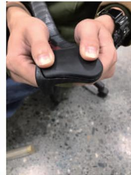
④ 用手按壓，使軟墊的肋條確實精準的進入手肘版的槽孔中。
